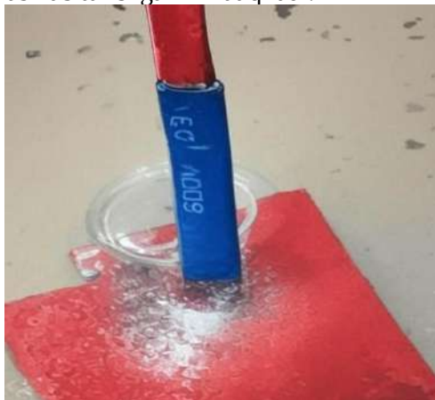
1-rasm. Suyuqlikdagi uchqunli sintez jarayonida nanozarralarning hosil bo'lishi tasviri.
