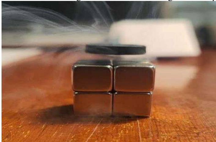
5-rasm. Suyuq azotda sovutilgan namunadagi Miessner effekti.
