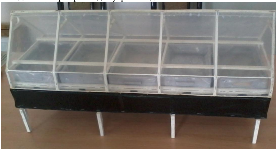
1-расим. Парникли қуёш сув чучутгичининг лаборатория кўриниши. Энергетик такомиллашган парникли қуёш сув чучутгичининг синов натижалари
