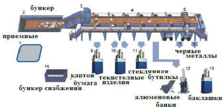
Рисунок 1: Схематическое изображение устройства для разделения бытовых отходов
