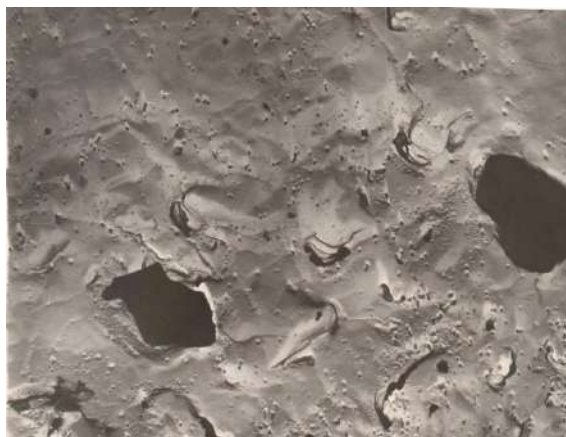
Рис. 2. РЭМ-картина поверхности Pd-Ba, снятая после эксплуатации в течение более 500 ч.
