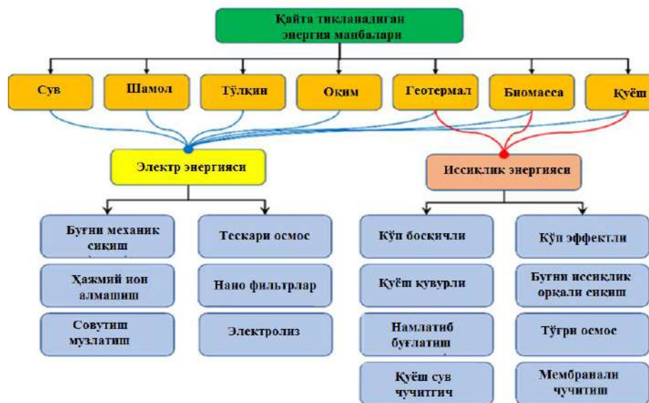
2-расм. Қайта тикланадиган энергия манбалари асосида ишловчи сувни чучитиш технологиялари.
