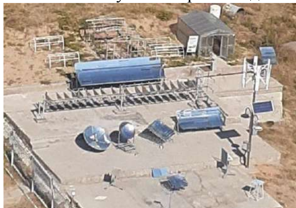
Рис.1. Инновационный полигон с малыми солнечными концентраторами, гибридной: ветро-солнечной комбинированной установкой.
