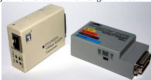
9-rasm. Tarmoq transiveri - ikkita turli xil fizik muhitdagi axborotlarni uzatuvchi va qabul qiluvchi qurilma.
