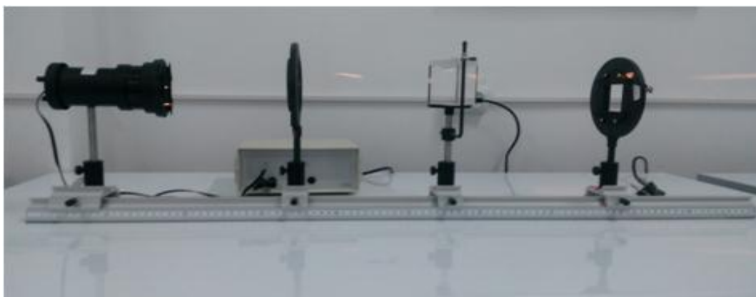
3-расм. Дисперсия ҳодисасини намоён этиш қурилмаси
