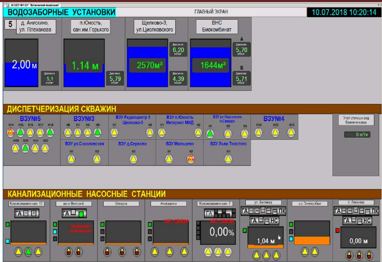
Рисунок 2. Визуальный вид диспетчерского управления водоканала
