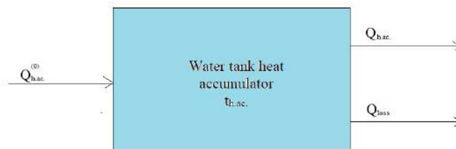
2-rasm. Suvli bak issiqlik akkumulyator issiqlik balansini hisob sxemasi
