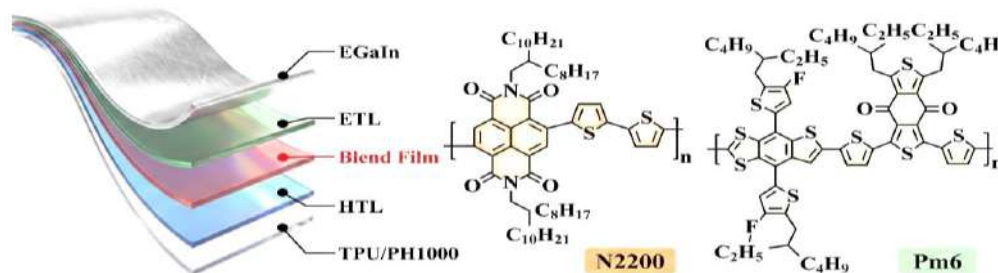
1-rasm. TPU/PH1000 asosidagi cho'ziluvchan OFE tuzilmasi hamda PM6 va N2200 donor/akseptor molekularining strukturalari
