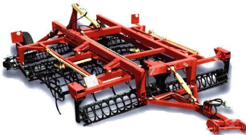
Рисунок 3. 3D комбинированного почвообрабатывающего агрегата с внесением удобрений
