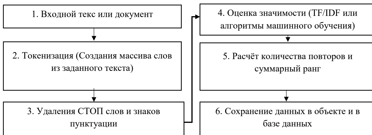
Рисунок 2. Описание работы механизма индексации
